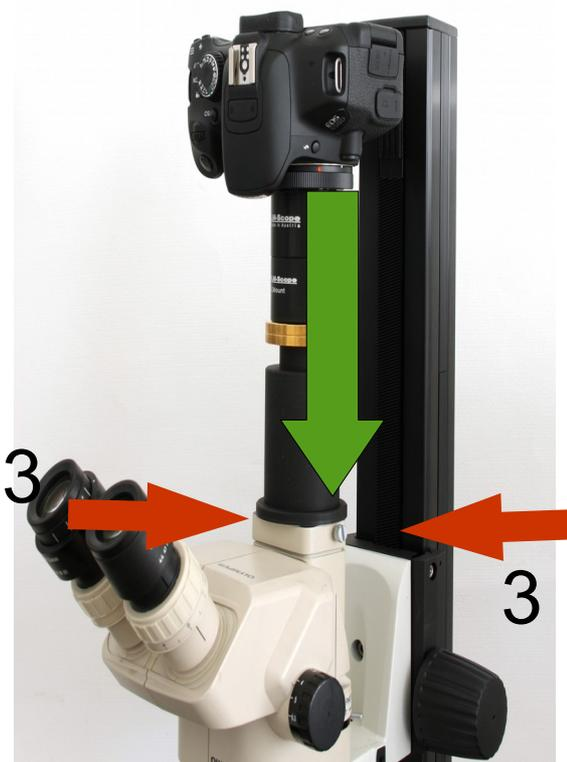
Entfernen Sie die Positionierungsschraube (siehe Bild 1). Nun schrauben Sie die beiden Rändelschrauben (3) heraus und stecken den TUST42C\_SZ in den Tubus (2). Anschließend fixieren Sie den C-Mount Port 1x wieder mit den beiden Rändelschrauben. Der TUST42C\_SZ soll fest sitzen und sich nicht mehr bewegen.
