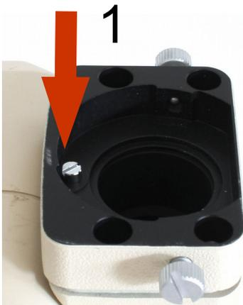
Demontieren Sie die alte Adapterlösung vollständig, so dass nur mehr der Basisstutzen (Fototubus) übrig bleibt. Der Fototubus besitzt eine kleine Positionierungsschraube, die für die neue LM Adapterlösung nicht mehr benötigt wird. Sollte diese Schraube für das Einsetzen des TUST42C\_SZ hinderlich sein (z.B. TUST42C\_SZ kann nicht komplett hineingesteckt werden), so empfehlen wir die Entfernung der Schraube.
