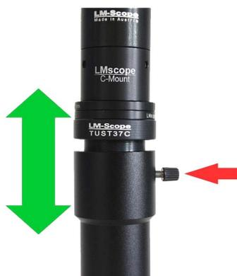
Ist die **optimale Position** gefunden, so wird der Tubus mit Hilfe der Rändelschraube wieder fixiert.
