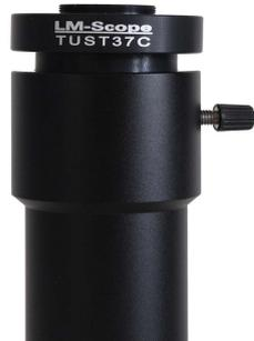
Der TUST37C (oder TUST38C) wird **in den Fototubus** des Mikroskops gesteckt, bzw. bei einigen LEICA Mikroskopmodellen in den **LeicaC1XTH Port**. Dann wird das Kamerasystem samt LM digital Adapter auf den TUST37C (oder TUST38C) installiert.
