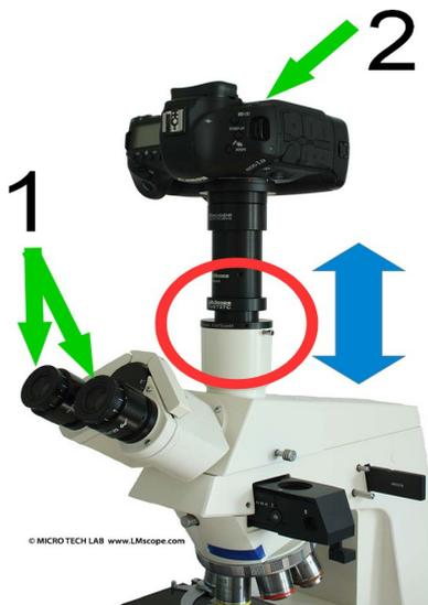
Im Anschluss an die Montage sollte ein **Abgleich zwischen Okularen und Fototubus** stattfinden. Erst durch das Einstellen der Parfokalität (d.h. gleichzeitig scharfes Bild im Beobachtungstubus und im Foto), ist ein ergonomisches Arbeiten möglich.
