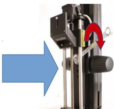
Richten Sie den Stackshot Macro Rail axial mit einer kleinen Wasserwaage aus und ziehen Sie die M8-Mutter fest.
