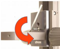
Demontieren Sie zunächst das LM Objektiv und dann die gesamte Objektivhalterung vom LM Stativ.
