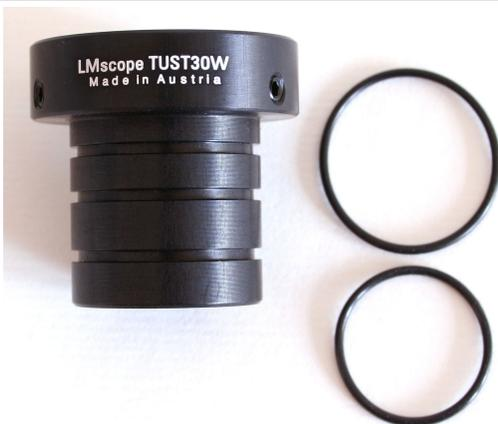
Je nach Mikroskop-Hersteller und Modell kann der Innendurchmesser des Okular-tubus einige Zehntelmmillimeter vom Sollmaß abweichen. Daher sind im Lieferumfang der Tubussteckhülse [TUST30W] mehrere unterschiedliche O-Ringe enthalten. Diese ermöglichen eine exakte Tubusanpassung.
