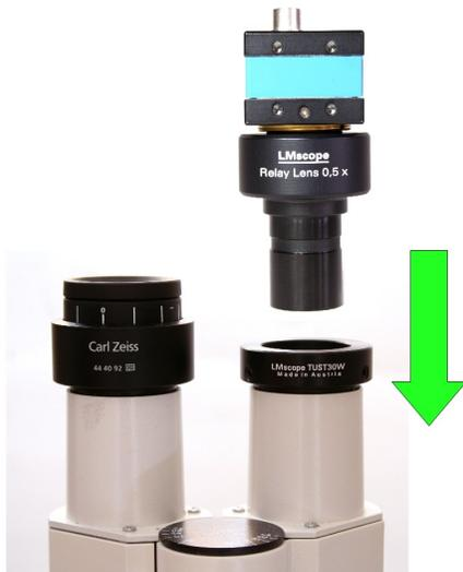
Nun können Sie die gesamte Einheit (LM Relay Lens Adapter und Videokamera) in den Okulartubus Ihres Mikroskops stecken.
