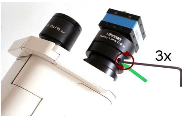
Fixieren Sie nun den LM Relay Lens Adapter mit Hilfe eines Inbusschlüssels.
