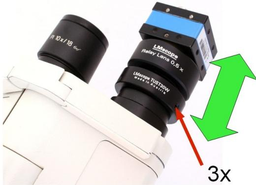
Fokusanpassung: Um das Bild optimal zu fokussieren, können Sie (wie bereits weiter oben beschrieben), den Abstand zwischen Adapter Tust30W und LM Relay Lens Adapter mithilfe eines Inbusschlüssels einstellen.
