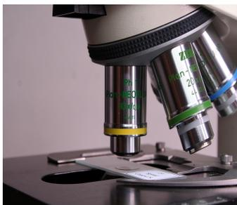
Schwenken Sie das 10-fach Mikroskop-Objektiv ein und stellen Sie mithilfe der Mikroskop-Fokussierung das Bild visuell über den Beobachertubus scharf. Optimal für perfekte Mikro-Fotos sind planachromatische, Plan Fluoride oder planapochromatische Mikroskopobjektive.
