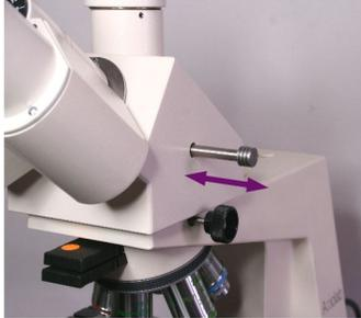
Falls Ihr Mikroskop keinen Strahlenteiler (z.B. 60/40) hat, denken Sie daran, das Umlenkprisma so zu stellen, dass Licht in den Fototubus gelangen kann.
