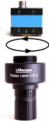
Montieren Sie die digitale C-Mount Videokamera auf den LM Relay Lens Universal Adapter.
