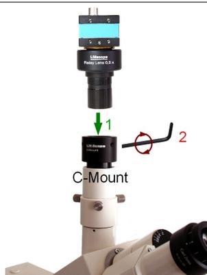
1) Nun können Sie die gesamte Einheit (LM Relay Lens Universal Adapter und Kamera) auf den C-Mount Photoport Ihres Mikroskops stecken.
