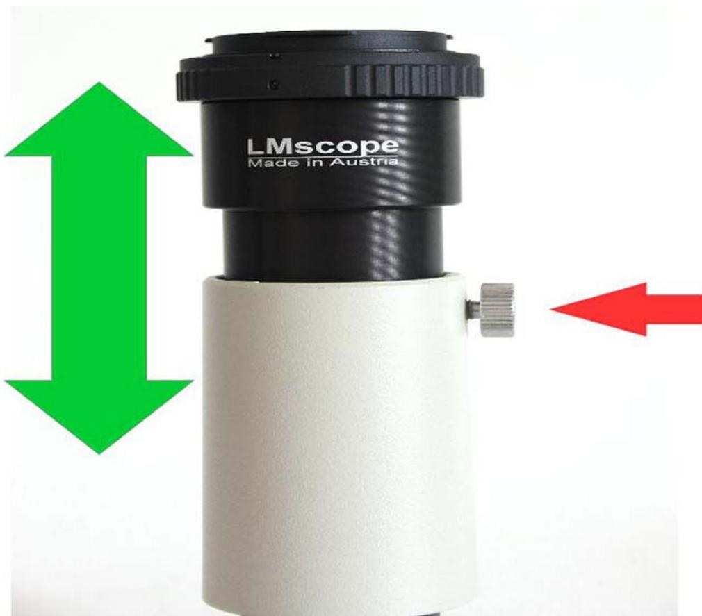
Nach der Montage der Kameraeinheit (Kamera und LM digital Adapter), sollte ein **Abgleich zwischen Okularen und Fototubus** durchgeführt werden. Erst durch das Einstellen der Parfokalität (d.h. gleichzeitig scharfes Bild im Beobachtungstubus und im Foto), ist ein ergonomisches Arbeiten möglich.
