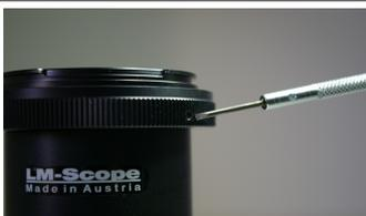
Mit den drei kleinen Schrauben des T2-Rings können Sie bei Bedarf die Kamera in eine andere Position drehen.
