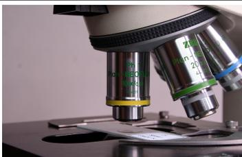
Schwenken Sie das 10-fach-Mikroskop-Objektiv ein und stellen Sie mithilfe der Mikroskop-Fokussierung das Bild visuell über den Beobachertubus scharf. Optimal für perfekte Mikro-Fotos sind planachromatische, Plan Fluoride oder planapochromatische Mikroskopobjektive.
