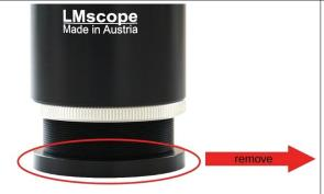
Um den Einsatzbereich zu erweitern, ist im Lieferumfang dieses Mikroskop Adapters ein **5mm C-Mount Extender** enthalten. Bei Instrumenten, die von der C-Mount-Norm abweichen, kann der Extender auch entfernt werden.
