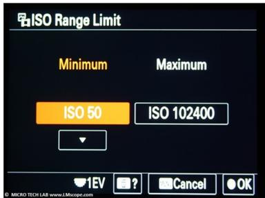
Bei homogener Ausleuchtung und hoher Lichtintensität erhält man bei **niedrigen ISO-Sensorempfindlichkeits-Einstellungen (50 bis 200) die besten Ergebnisse**. Bei niedrigen ISO-Einstellungen besitzt die Kamera den **höchsten Dynamikumfang**.
