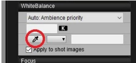
Für hohe Bildqualität und natürlich wirkende Farben sollte ein **Weißabgleich** in der Kamera durchgeführt werden: entweder im Kameramenü mit der Einstellung des Kelvin-Wertes der Lichtquelle oder exakter mithilfe der
