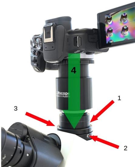
Vor der Montage der Adapterlösung lockern Sie die **Fixierschrauben** so weit, dass der Adapter gut in den Fototubus gesteckt werden kann (4). **Je nach Mikroskop kann es zwischen einer und drei Schrauben geben.**
