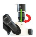
**Stecken** Sie die Adapterlösung in den Fototubus und **fixieren** Sie sie durch **Rotation** im Uhrzeigersinn.
