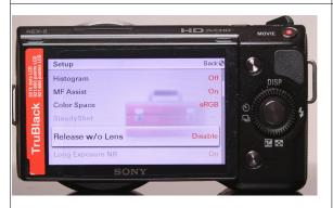
Bei einigen Kameras ist ein Auslösen nur mit montierten Objektiven möglich. Sollte dies bei Ihrer Kamera zutreffen, so stellen Sie im Menü "Einstellungen" den Punkt "Auslöser ohne Objektiv" ein (Wortwahl bei jedem Hersteller etwas anders).
