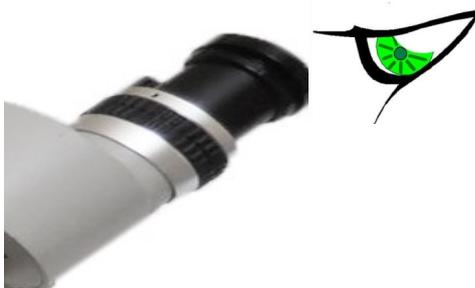
Zum Anpassen des Fokus, also zur Erreichung der Parfokalität, ist die Adapterlösung fokussierbar.
