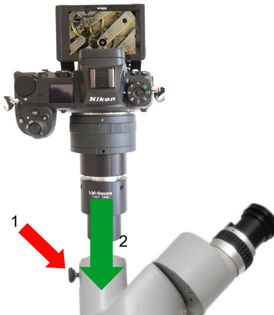
Sollte auf dem Mikroskop eine andere Adapterlösung montiert sein, entfernen Sie diese komplett, sodass der Basis-Fototubus mit 36mm Innendurchmesser freiliegt.
