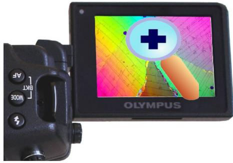
Kamerasucher bzw. Winkelsucher scharf. Für die präzise Scharfstellung sind DSLR- oder Systemkameras (DSLM) mit „Live View“ Modus und Lupenfunktion (7x/10x/14x) ideal. Eine Lupenfunktion ist von Vorteil, da das Display der Kamera nicht die gleiche Auflösung hat wie der Sensor. Nicht alle Kameramodelle besitzen eine Lupenfunktion. Ebenfalls empfehlenswert ist das Benützen eines externen HD-Monitors, welcher idealerweise über einen HDMI-Anschluss mit der Kamera verbunden ist.
