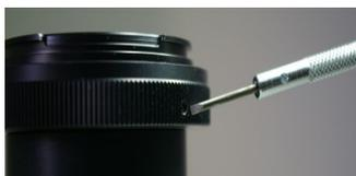
Sollte die Kamera nicht optimal ausgerichtet sein, so können Sie die drei kleinen Schrauben des T2-Rings lockern, um die Kamera in eine andere Position zu drehen.
