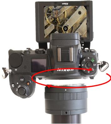
Montieren Sie den LM Adapter mithilfe des Bajonetts auf Ihre Kamera. Achten Sie dabei darauf, den Punkt am Bajonettgewinde genau auf den Punkt am Kameragewinde aufzusetzen, bevor Sie im Uhrzeigersinn drehen, bis es einrastet. Bei Bedarf halten Sie den Knopf für das Lösen des Kameragewindes gedrückt.
