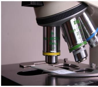
Schwenken Sie das 10-fach-Mikroskop-Objektiv ein und stellen Sie mithilfe der Mikroskop-Fokussierung das Bild visuell über den Beobachtertubus scharf. Optimal für perfekte Mikro-Fotos sind planachromatische, Plan Fluoride oder planapochromatische Mikroskopobjektive.
