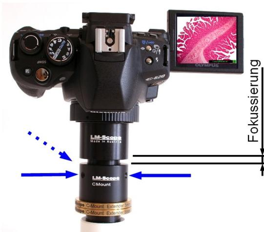
Um das Bild optimal zu fokussieren, können Sie (wie bereits weiter oben beschrieben) den Abstand zwischen C-Mount Erweiterung und LM Adapter mithilfe eines Inbusschlüssels einstellen.
