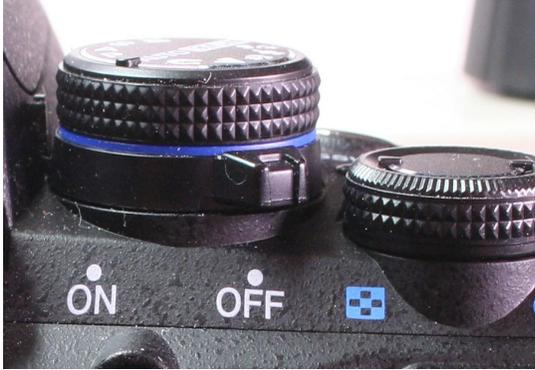
Schalten Sie die Kamera ein und benutzen Sie, wenn möglich, das Automatikprogramm. Sollte dies nicht möglich sein, so wählen Sie das Programm Zeitautomatik. Wenn beide oben genannten Varianten nicht funktionieren, so können Sie auch im „M“ (Manuell) – Modus arbeiten. Wir empfehlen Ihnen, das Intervall des Stromsparmmodus Ihrer Kamera zu verlängern, sonst schaltet sich die Kamera ständig aus.
