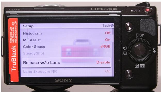
Bei einigen Kameras ist ein Auslösen nur mit montierten Objektiven möglich. Sollte dies bei Ihrer Kamera zutreffen, so stellen Sie im Menü „Einstellungen“ den Punkt „Auslöser ohne Objektiv“ ein (Wortwahl bei jedem Hersteller etwas anders).
