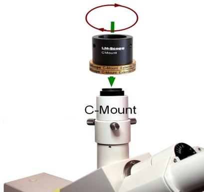
Schrauben Sie nun die C-Mount Erweiterung im Uhrzeigersinn auf den Phototubus Ihres Mikroskops.
