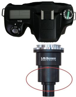
Montieren Sie den LM Digital Adapter mithilfe des Bajonetts auf Ihre Kamera. Achten Sie dabei darauf, den Punkt am Bajonett genau auf den Punkt am Kameragewinde aufzusetzen, bevor Sie im Uhrzeigersinn drehen bis es einrastet. Bei Bedarf halten Sie den Knopf für das Lösen des Kameragewindes gedrückt.
