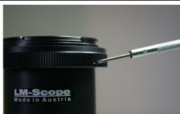
Mit den drei kleinen Schrauben des T2-Rings können Sie bei Bedarf noch die Kamera in eine andere Position drehen.
