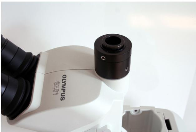
Serienmäßig wird das Stereomikroskop Olympus SZ61 TR mit einem C-Mount Anschluss mit integrierter 0,5x Optik angeboten. Da diese Optik das Bildfeld um ca. 50% verkleinert, sollte sie unbedingt entfernt werden, wenn mit Kameras mit hochwertigen großen Sensoren (Fourthirds, APS-C, Fullframe) gearbeitet wird. Da das Risiko einer Beschädigung des Mikroskops besteht, lässt man es idealerweise bereits vor der Mikroskopauslieferung umbauen, oder durch einen Fachhändler oder geschulten Techniker.
